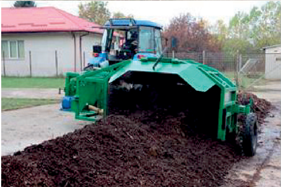
Figura 1 - Instalația de afânare biohumus - IAB
