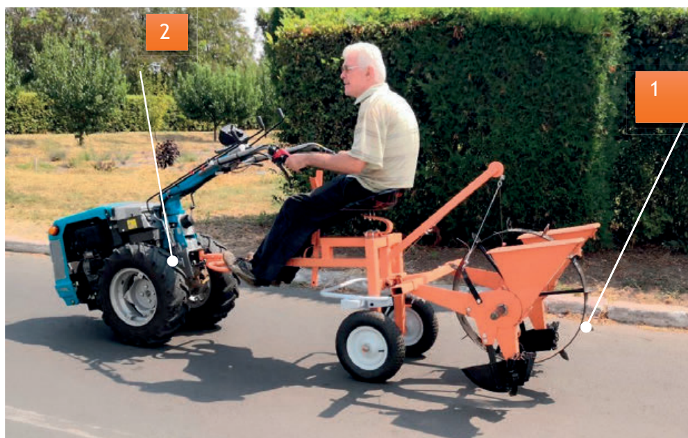
Figura 1 - Modelul experimental al echipamentului pentru semănat plante tehnice, SPT 1 - Echipament SPT; 2 - Motocultor
