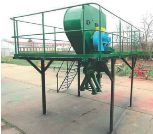
Modul de condiționat semințe de legume MCSL
