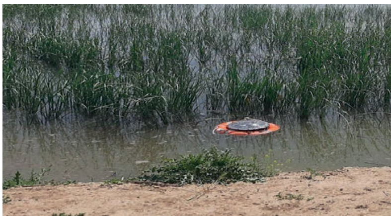
Figura 1 - Baliza-sondă de monitorizare a calității apei
